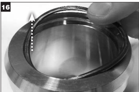
スリーブからシャフトO-リング (V) を外し、廃棄します。
