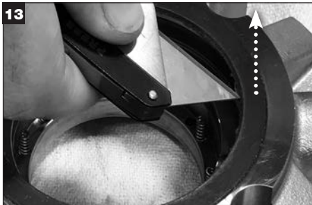
グランドからスタッフィングボックスフェースガasketを外し、廃棄します。
