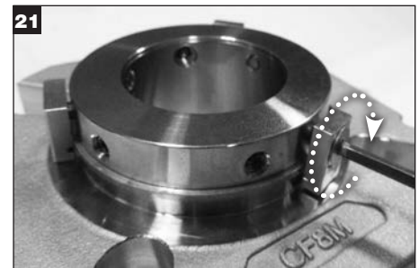
21 センタリングクリップのフラットヘッドスクリューを使って、ロックリングの外径上にセンタリングクリップを取付けます。
